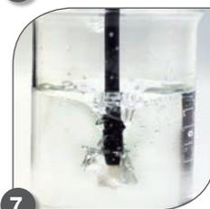
La sonda del agitador ofrece una mezcla de muestras uniforme, ayuda a evitar que los electrodos sufran daños y es fácil de lavar entre las muestras.
