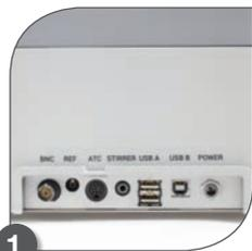
Los puertos de conexión del titulador cuentan con funciones claramente etiquetadas, e incluyen tres puertos USB para impresoras, unidad de memoria flash USB y conexiones a programas informáticos.
