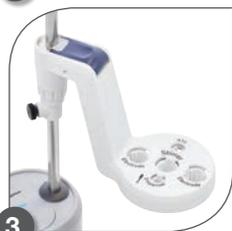
Los portaelectrodos ofrecen un desplazamiento seguro y firme de los electrodos durante todo el proceso de medición.
