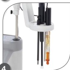
Combine el titulador con la tecnología de electrodos de pH ROSS para proporcionar un sistema de medición completamente optimizado para generar análisis de muestras precisos y reproducibles.
