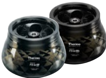
Fiberlite F10-6x100 LEX Fixed Angle Rotor, 45°, R max 122 mm
