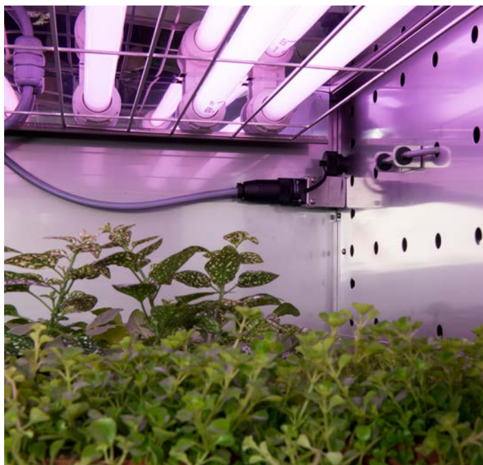
Interior de una cámara de luz vertical Thermo Scientific con módulos de luz para el crecimiento vegetal instalados.
