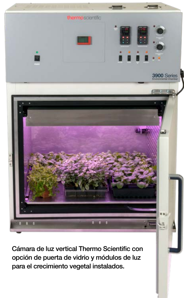
Interior de una cámara de luz vertical Thermo Scientific con módulos de luz para el crecimiento vegetal instalados.
