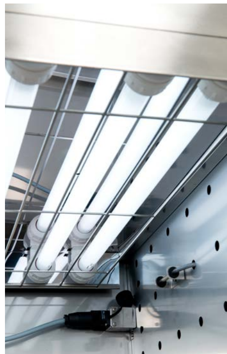
Interior de una cámara de luz vertical Thermo Scientific con módulos de luz para la incubación de animales instalados.
