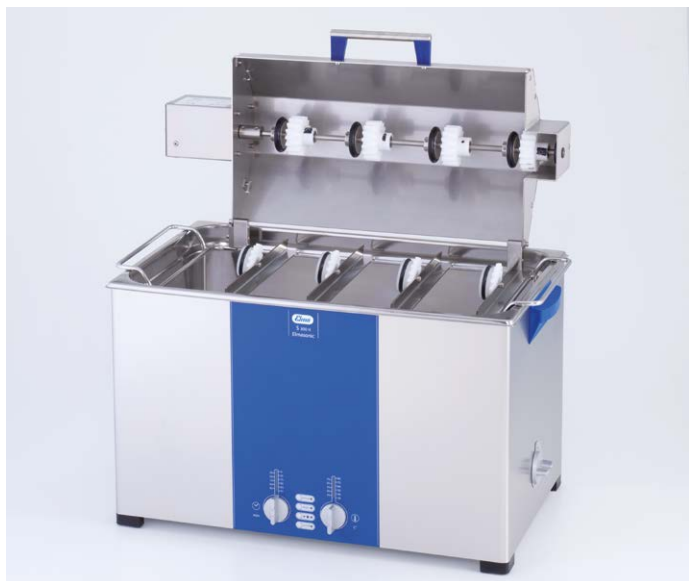
Elmasonic S 300 (H) y módulo para tamices SRH 4/200
